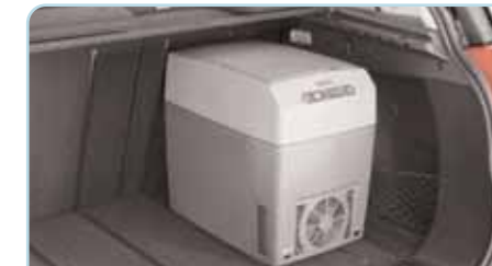
Module isotherme Ce module est doté des fonctions froid et chaud pour transporter à bonne température vos boissons ou aliments. Il dispose d'un système d'ancrage Isofix.
