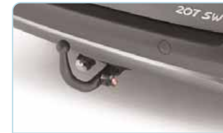
Attelage à rotule démontable sans outil Un simple geste permet d'enclencher ou d'éjecter la rotule de son boîtier. 207 SW retrouve alors sa ligne d'origine.
